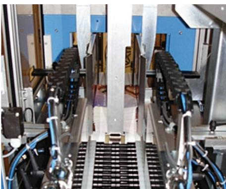
Der Pusher des Servo-Handling-Systems schiebt den Stapel seitlich geführt auf das Shuttleworth der Banderoliermaschine. Der Fördergurt übernimmt den Produktstapel. Der ganze Einlauf ist mit verstellbaren Seitenführungsblechen ausgerüstet. Mittels Schnellverstellhebeln erfolgt die Format-Einstellung.
