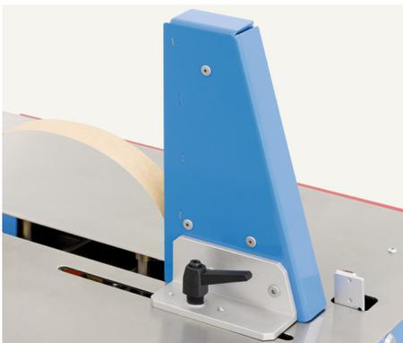
Die Justierung der Stützhörner wird durch die neue Schnellverstellung vereinfacht und beschleunigt.
