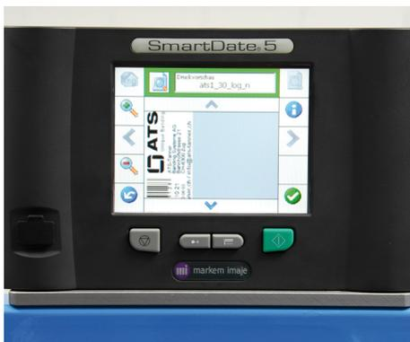
Druckersteuerung mit Display als Option zur Anzeige der aktuellen Druckdaten.
