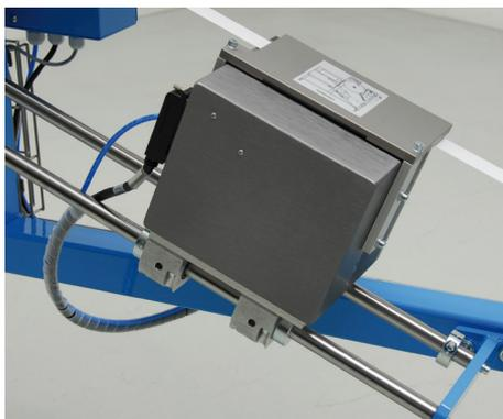
Einfache Verstellbarkeit des Druckkopfes zur optimalen Positionierung des Druckbildes auf der Banderole und dem Produkt.
